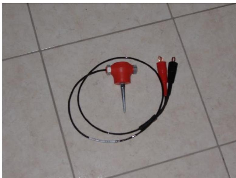
**Figura 13** – Geofono Geospace GS 11D da 4.5 Hz.
