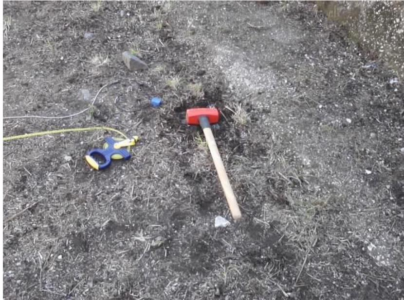
**Figura 14** – Martello sismico da 10 kg impiegato come sorgente sismica.
