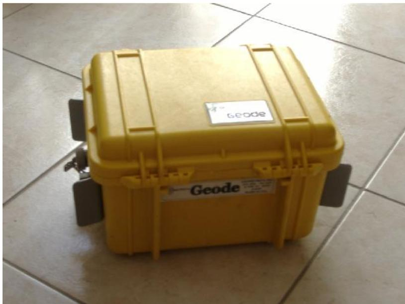
**Figura 12** – Sismografo Geode Geometrics a 24 canali.
