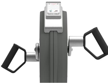
Il fattore Q della bici da braccio è di 175 mm, la pedivella è in acciaio inossidabile da 18 mm e collega i bracci del pedale che sono parti in acciaio inossidabile fuso (grado 304). La lunghezza dei bracci del pedale è di 170 mm e i pedali sono collegati con raccordi standard per bici.
