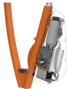
L'innovativo motore elettrico autoalimentato e gli ingranaggi forniscono un volano virtuale per offrire un'esperienza di ciclo reale. La resistenza funziona come un azionamento automatico e si adatta automaticamente alla velocità di pedalata. Gli utenti possono sovrascrivere manualmente l'unità automatica modificando la resistenza in passi (26 - Watt) tramite l'app.
