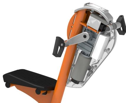
L'innovativo motore elettrico autoalimentato e gli ingranaggi forniscono un volano virtuale per offrire un'esperienza di ciclo reale. La resistenza funziona come un azionamento automatico e si adatta automaticamente alla velocità di pedalata. Gli utenti possono sovrascrivere manualmente l'unità automatica modificando la resistenza in passi (26 - Watt) tramite l'app.
